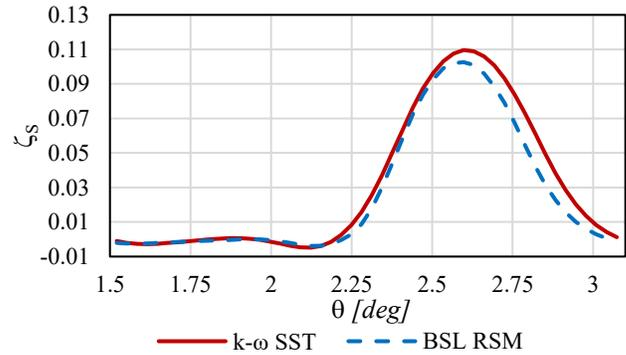
FIGURE 16 STATOR LOCAL LOSS COEFFICIENT VS. CIRCUMFERENTIAL LOCATION
