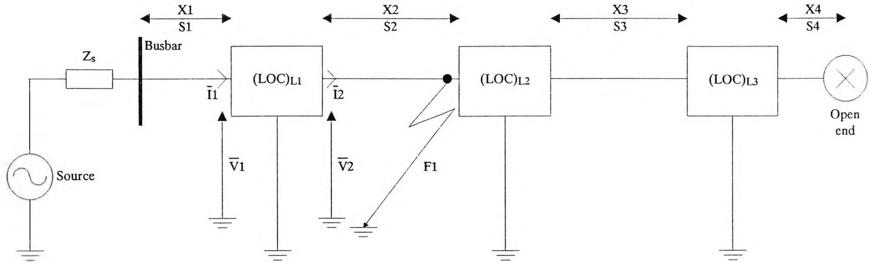
FIG(4.1), SCHEMATIC DIAGRAM OF THE SIMULATED SYSTEM PER PHASE.
