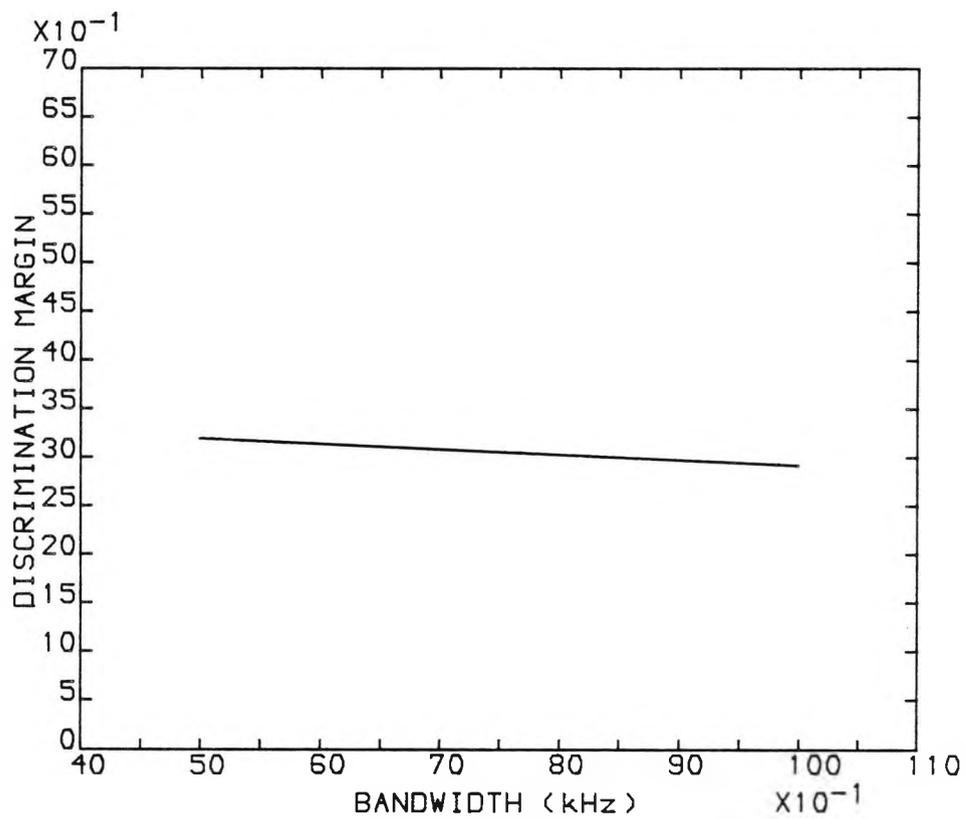
FIG (5.21). VARIATION OF DISCRIMINATION MARGIN AGAINST BANDWIDTH OF STACK TUNERS AND LINE TRAP CIRCUIT OF EACH LOCATOR
