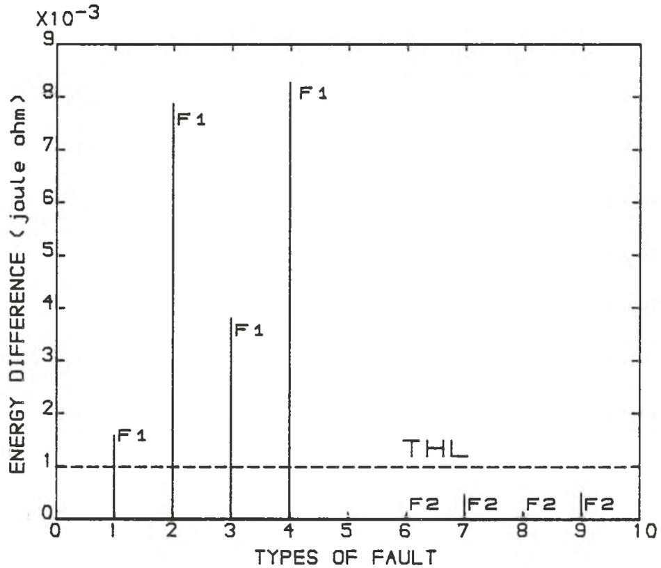
FIG (6.25). DISCRIMINATION BETWEEN IN-ZONE AND OUT-OF-ZONE FAULTS
