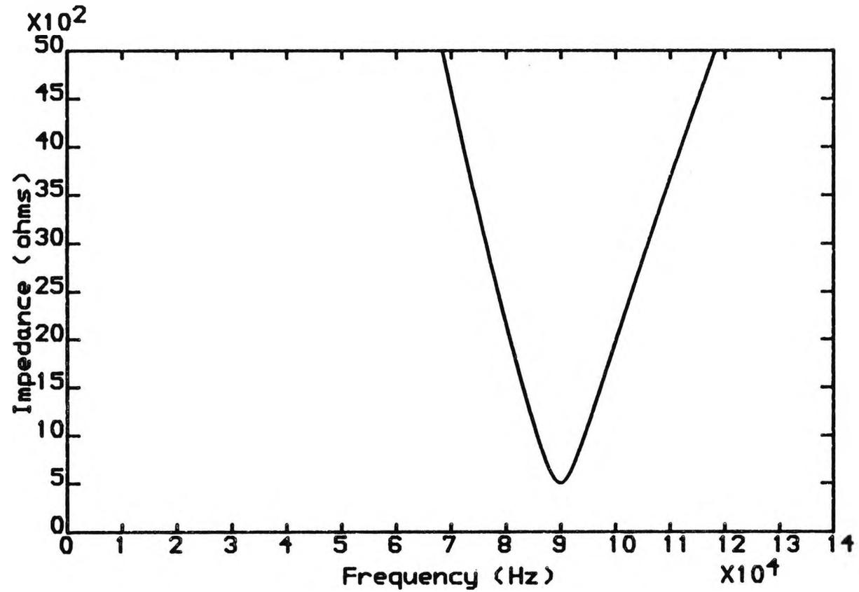
FIG(2.7), THE VARIATION OF IMPEDANCE OF EACH STACK TUNER AGAINST FREQUENCY.
