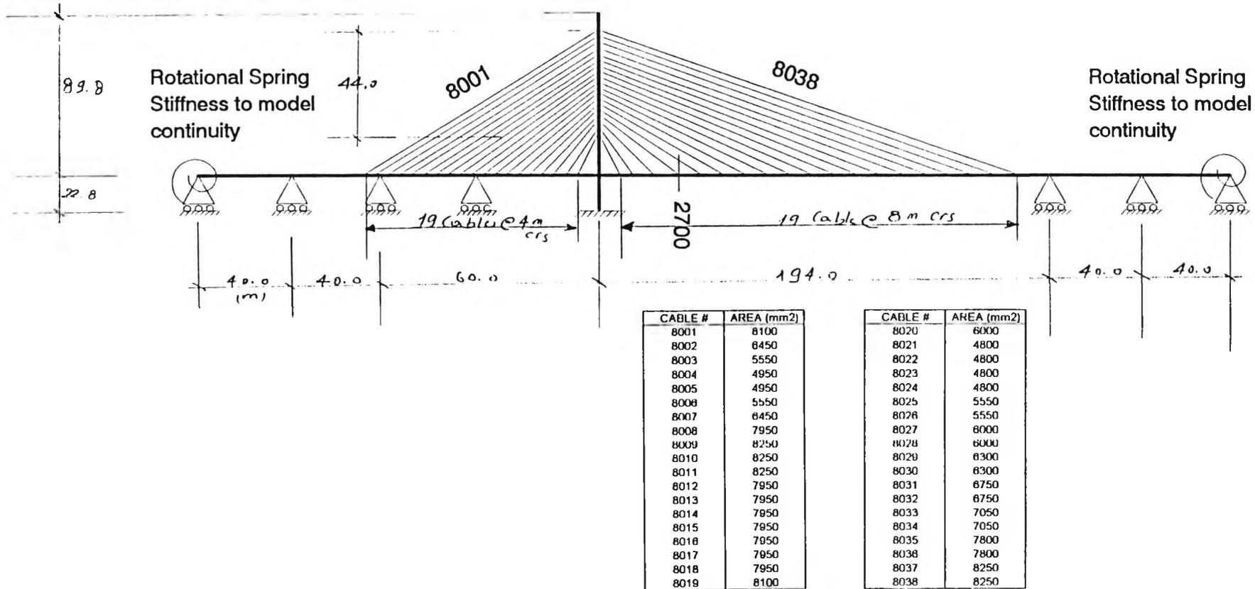
FIGURE A.2. STRUCTURE LONGITUDINAL CROSS SECTION.
