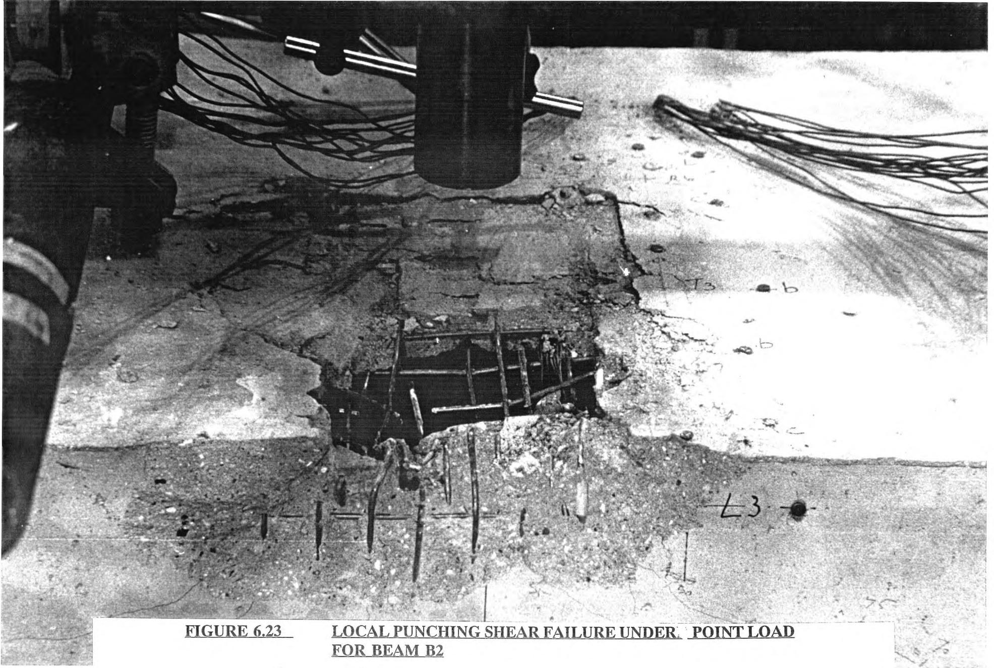
**FIGURE 6.23** LOCAL PUNCHING SHEAR FAILURE UNDER POINT LOAD FOR BEAM B2
