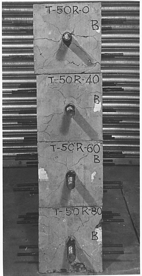
FIG. 6.17 TYPICAL FAILURE MODES UNDER TENSION RELEASE - TORBAR
