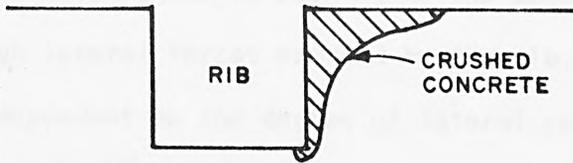
b. INTERMEDIATE CRUSHING
