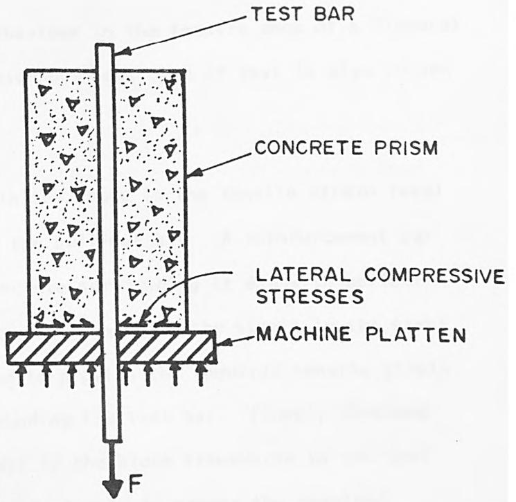
FIG. 3.1 PULL - OUT TEST ARRANGEMENT
