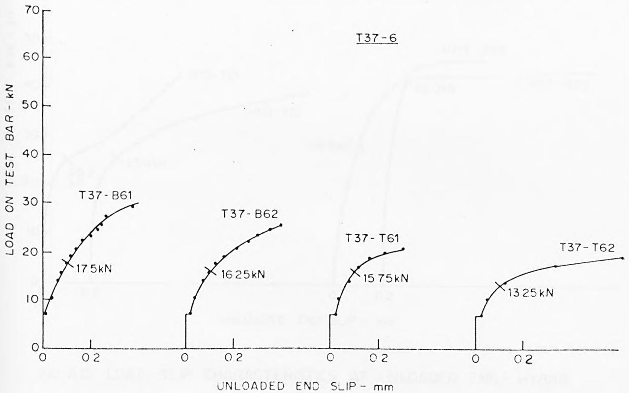
FIG A14 LOAD-SLIP CHARACTERISTICS AT UNLOADED END - TORBAR
