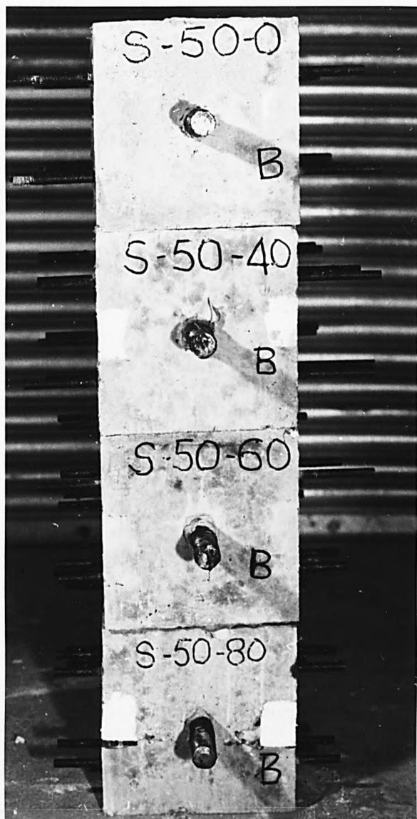
FIG. 6.19 TYPICAL FAILURE MODES UNDER TENSION RELEASE - SQUARE-TWISTED BAR
