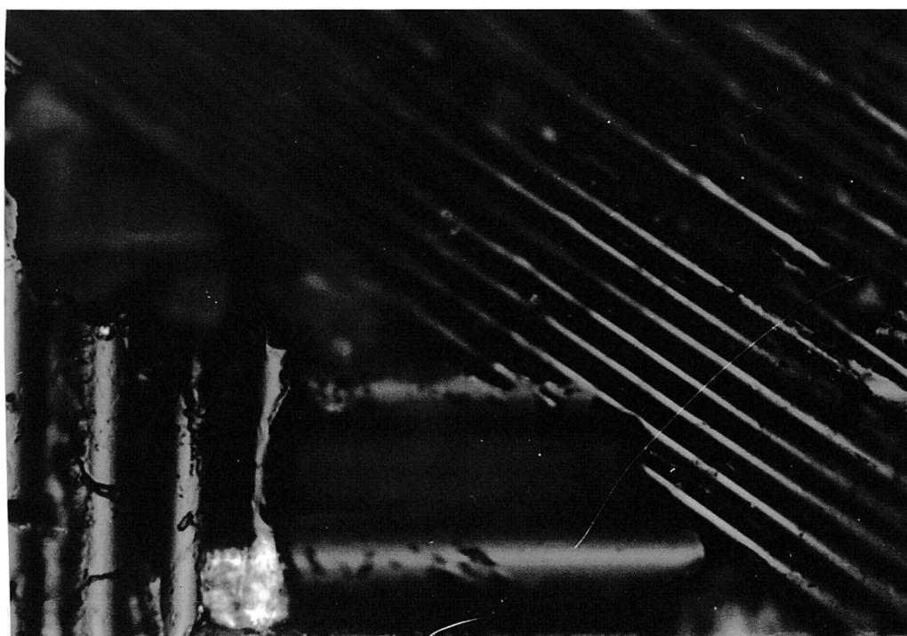
**FIG.108c** OPTICAL MICROGRAPH OF GRP SHOWING EFFECT OF DELAMINATION AND LAYER BY LAYER EROSION
