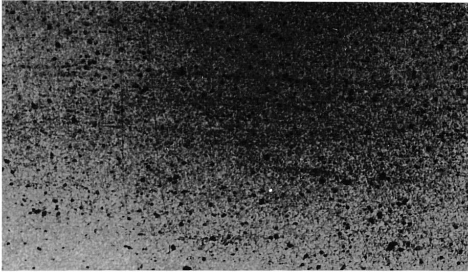
**FIG.107a** SURFACE OF SILICON NITRIDE PRIOR TO TESTING
