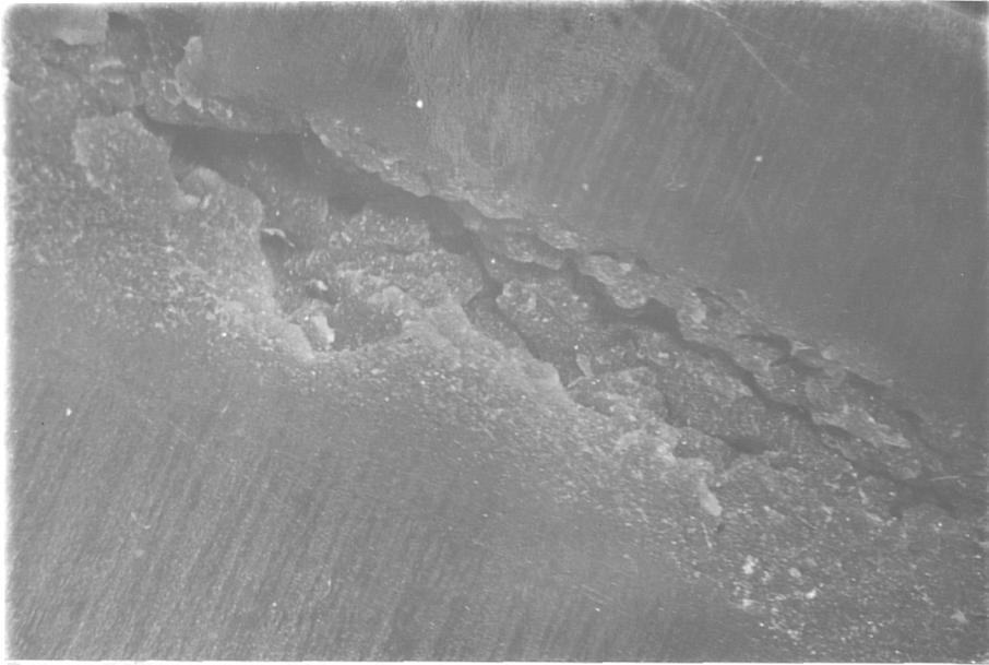
**FIG.102c** MICROSCOPIC VIEW OF GROSS DAMAGE ON ONE ERODED
